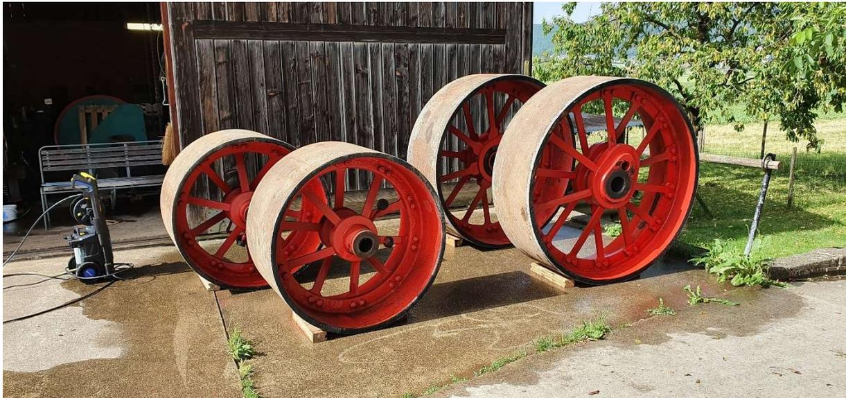
Die Walzenräder stehen bereit für den Transport zum Sandstrahler.
