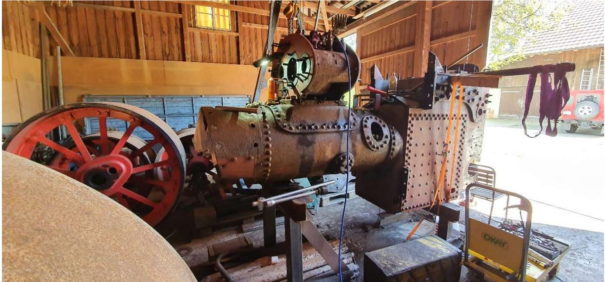
Ein erster grosser Schritt war das Ausbauen des noch im Zylinderblock klemmenden Hochdruckkolbens. Dieser konnte erst mit der grossen Hydraulikpresse und viel gut Zureden durch Jörg gelöst werden.
