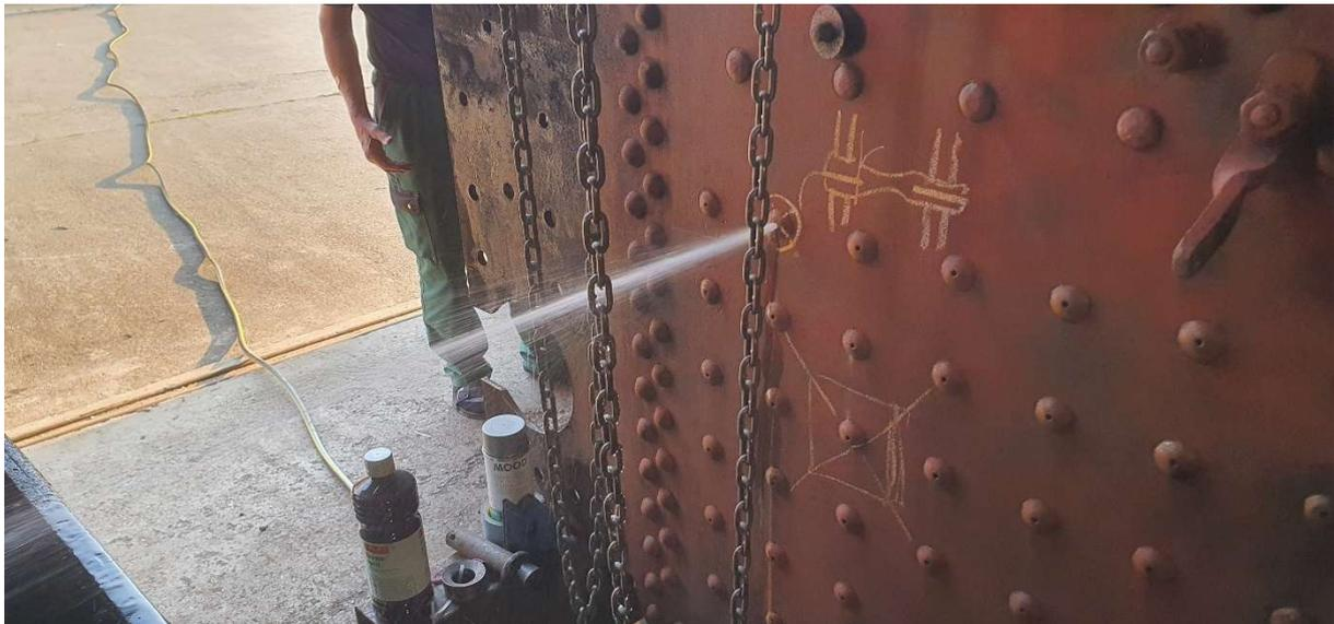
Dieser Stehbolzen ist definitiv gerissen. Nach dieser Aufnahme wurde er mittels Schraube verschlossen, um weitere defekte Stehbolzen finden zu können.
