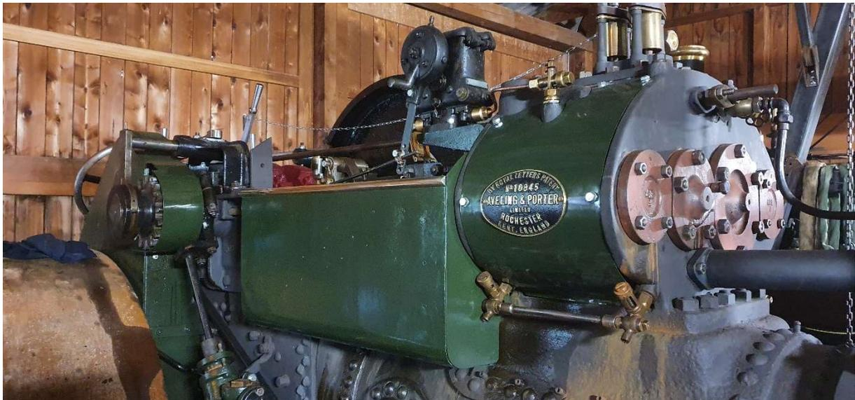
Um trotz fehlender Kesselverschalung etwas grün an die Maschine zu bringen, wurden die beiden Maschinenverschalungen und das eine noch brauchbare Zylinder-Verschaltungsblech angebracht.
