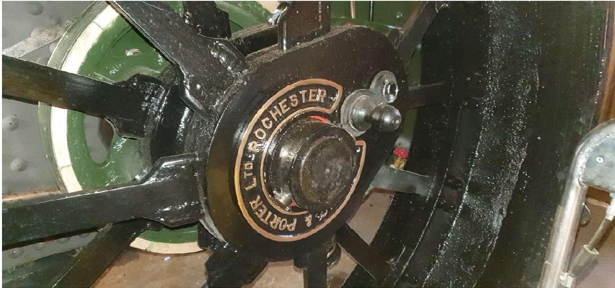
Zeit für Details: Die beiden neu gegossenen «Hufeisen» wurden an den hinteren Walzen befestigt. Beachtenswert auch die von Jürg Birk neu angefertigten Bremsklötze der Bandbremse.
