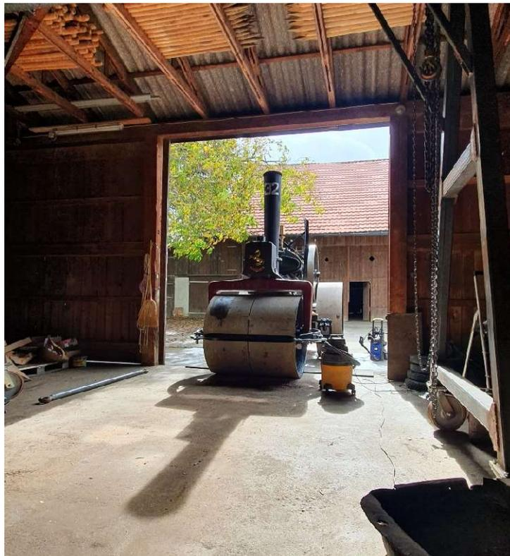
Im 2023 ist nun die weitestgehende Fertigstellung der Walze angedacht. So muss das Dach neu gestrichen und montiert werden, die Kesselverschalung und das Hilfsdampfventil fehlen noch, und Zierlinien soll die Maschine ebenfalls bekommen.
