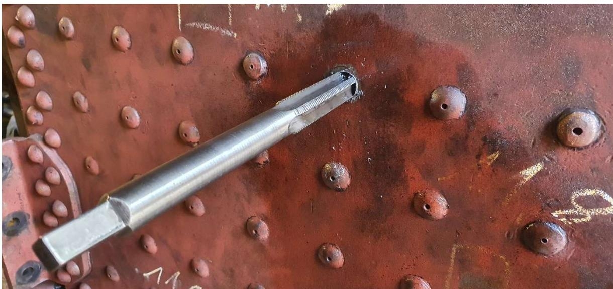
Nach den beiden Treffen ging es mit Elan am Kessel weiter. Die Bohrungen für die Stehbolzen wurden ausgerieben und neue Gewinde geschnitten.
