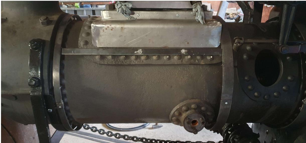
Mit jedem Blech, dessen Konturen nachgearbeitet waren vervollständigte sich das Erscheinungsbild der Walze weiter. Der Einfachheit halber sind alle Bleche auf den Tragringen festgeschraubt. Die kleinen M5 Senkschrauben werden später durch die Messingbänder verdeckt.
