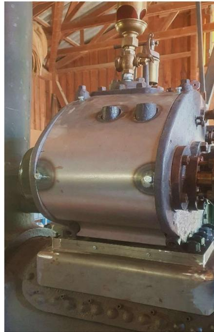
Im Anschluss wurde das Verschalungsblech der Stehkesseldecke angepasst. Leider konnte dieses nicht wie vorgesehen in einem Stück montiert werden. Zweigeteilt gelang die Montage dann problemlos. Dies bedingte allerdings, dass die Trennstelle zusätzlich abgestützt werden musste. Als diese «Fingerübungen» abgeschlossen war, ging es an die Verschalungsbleche des Langkessels. Diese wurden grob an den Kessel angepasst und kontrolliert, ob sie richtig geliefert wurden.
