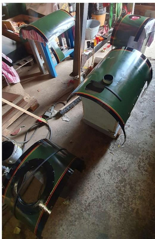
Nach dem Auftrag einer schützenden Schicht Klarlack konnten die Verschalungsbleche wieder am Kessel angebaut werden. In demselben Arbeitsschritt wurden auch diverse bisher blanke Schraubenköpfe lackiert. Einzelne Köpfe bedurften einer speziellen Behandlung, da die Linierung über sie hinwegführt. Diese sollte optisch möglichst nicht unterbrochen werden.
