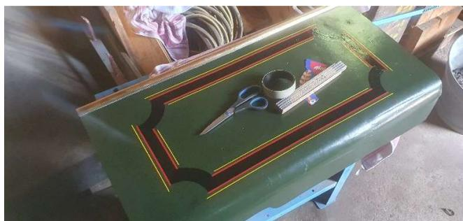
Die Linierung in den Flächen wurde auf ähnliche Weise angebracht. Zuerst wurden die schwarzen Flächen lackiert, danach das Linierklebeband aufgebracht und die roten und gelben Linien gemalt. Rundungen wurden danach mit einer Schablone auf das Blech vorgezeichnet und mit dem Linierroller vervollständigt.
