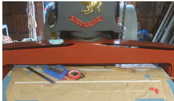
Während die schwarzen Flächen in bewährter Weise abgeklebt wurden erfolgte das Anbringen der roten Linien von Hand, der Farbtrekkante von schwarz zu rotbraun folgend.
