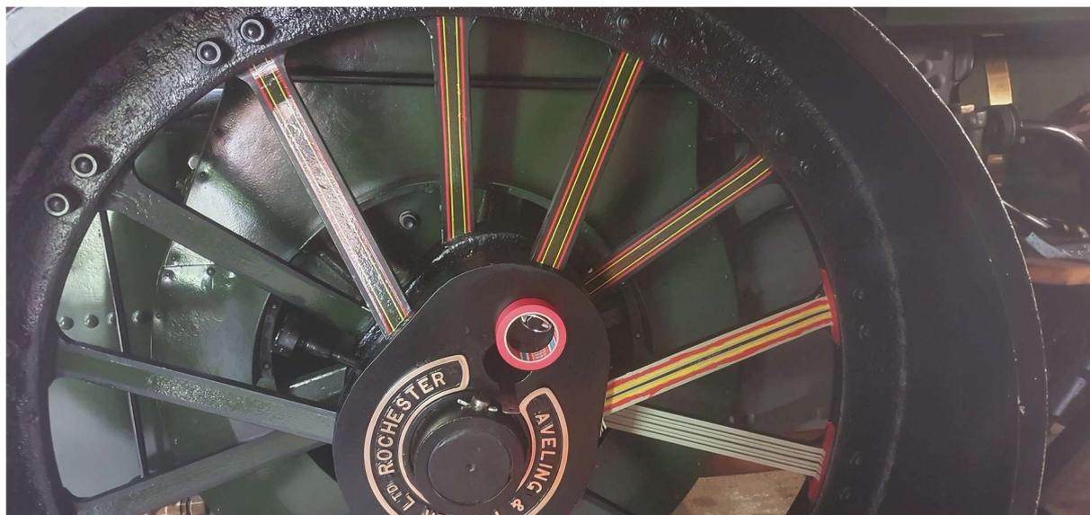
Recherchen haben ergeben, dass Aveling & Porter während der Fertigung der Kolbenschieber-Maschinen eine neue Linierungsvariante einführte. Diese weicht insofern von der davor angewendten Variante ab, dass die Linierung der Speichen am Ende gerade durchläuft und nicht mehr der Kontur folgt, sowie der Wechsel von rot innen / gelb aussen auf rot aussen / gelb innen.
